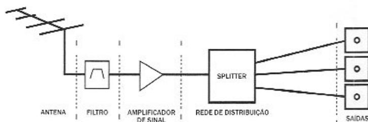
O filtro deve ser instalado por um profissional habilitado diretamente após uma antena ou antes de um amplificador de sinal para garantir a máxima mitigação de interferência. Os conectores são F Fêmeas.
