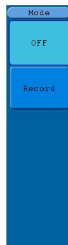
Figura 5-49: Menu de Gravação de Onda para Armazenamento Externo
