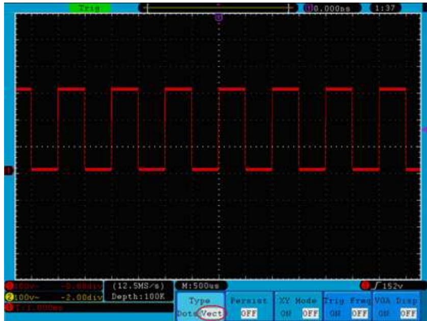
Figura 5-31 Exibição do Tipo Vetor ( Vect ).
