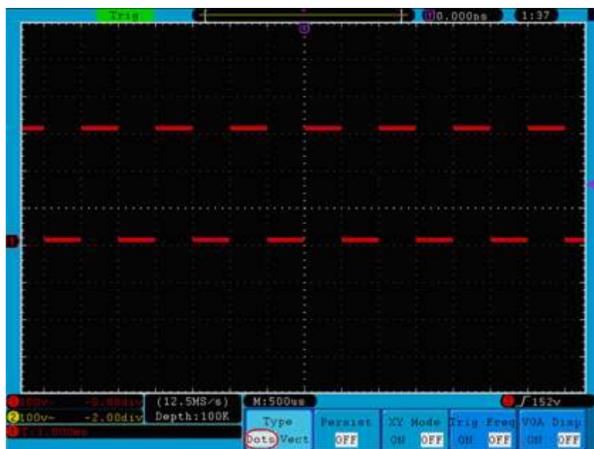
Figura 5-32 Exibição do Tipo Pontos ( Dots ).
