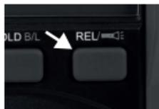
Usando o modo Relativo para desconsiderar a resistência das pontes ao se efetuar uma medição de uma resistência de valor muito baixo: Encostadas as duas pontas de prova, o display indicará algo em torno de 0,1 ou 0,2  $\Omega$  o que acarretaria em um erro na leitura de um resistor de, por exemplo, 0,47  $\Omega$ . Apertando o botão REL, o equipamento vai zerar o display e fará a medição desconsiderando a resistência das pontas de prova.
